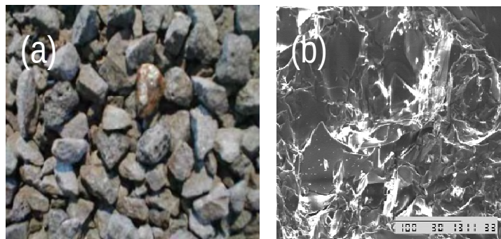
Slika 3. (a)Foto i (b) SEM snimke troske iz proizvodnje visokougljičnog ferokroma (veličina zrna 0/16 mm).
