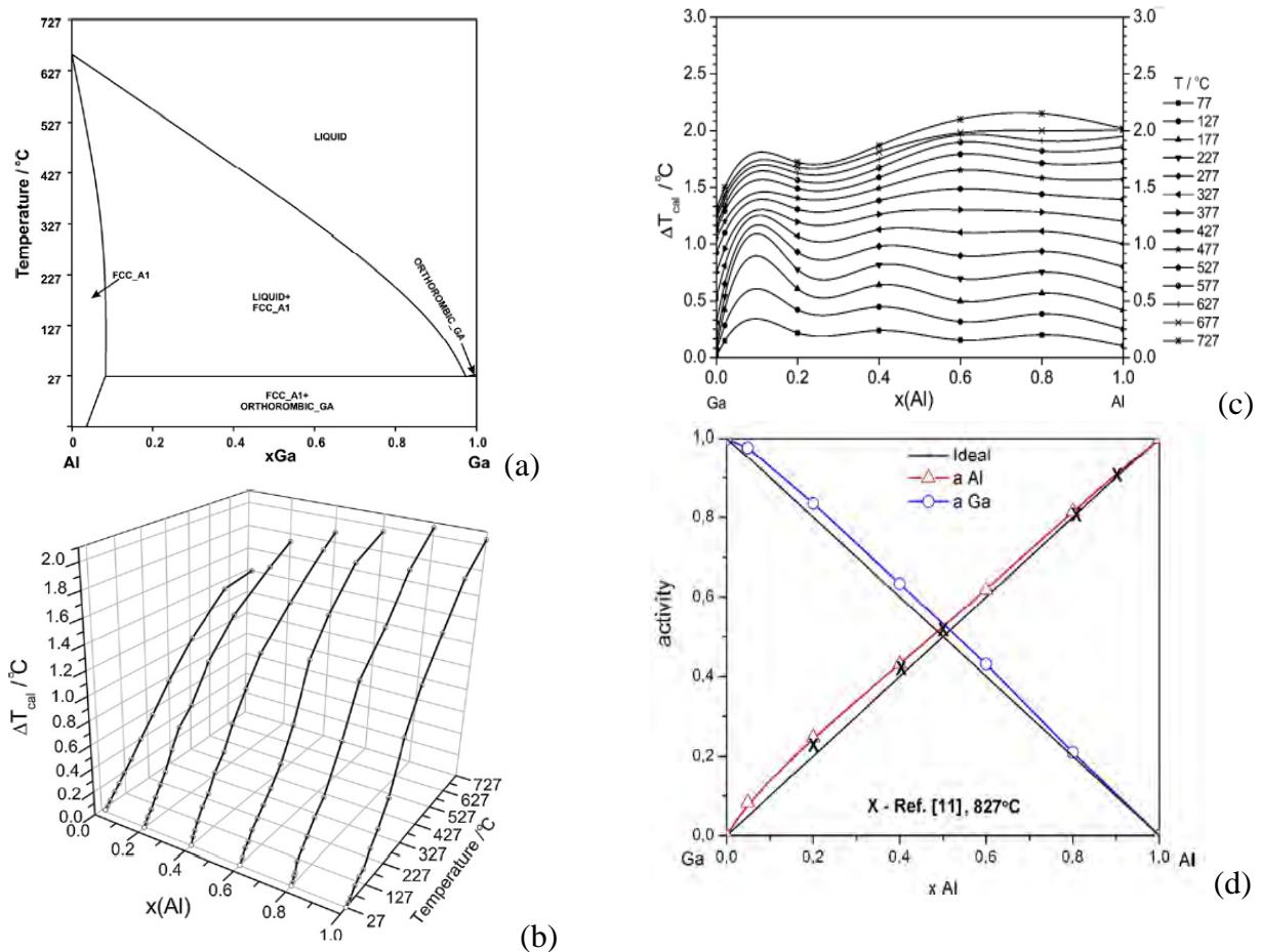
Slika 1. Fazni dijagram (a) i eksperimentalno odredjene termodinamičke karakteristike sistema Ga-Al (b-d) - preuzeto iz Ref. [4]
