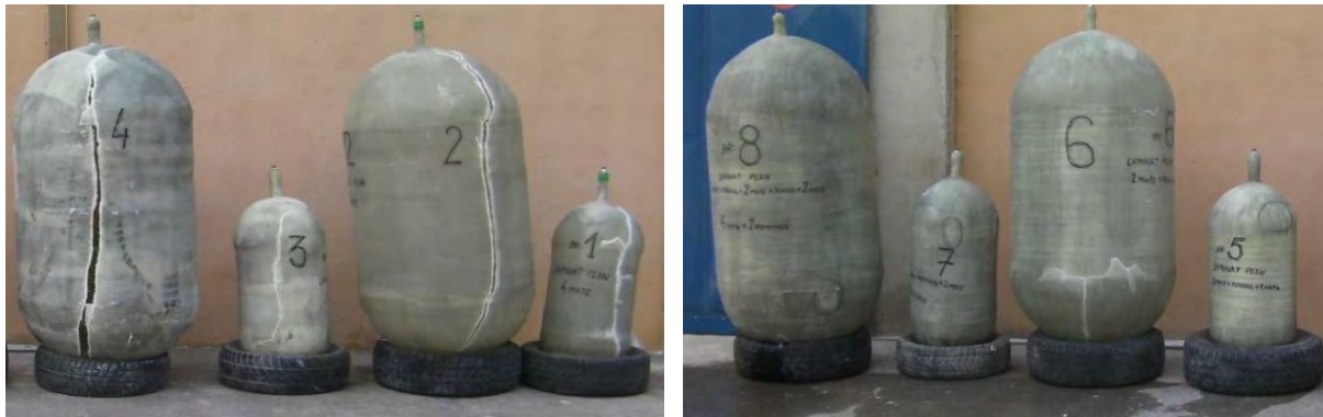
Slika 6. Izgled popuštanja posuda izrađenih od ojačanja u obliku mate (lijevo), odnosno kombinacija mata i rowing(desno)
