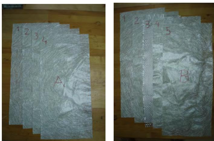
*Slika 1. Ojačanja korištena za izradu epruveta*
