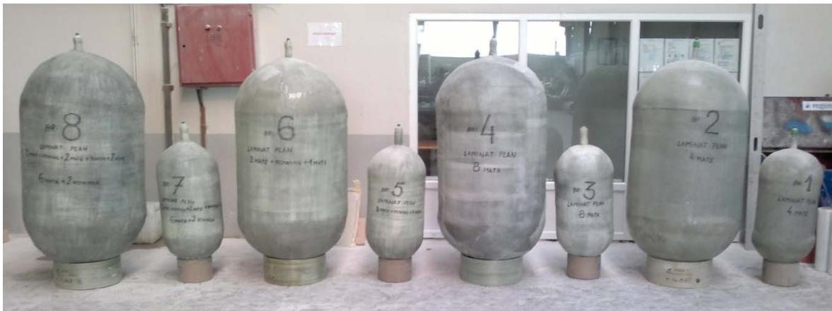
Slika 5. Posude od kompozitnih materijala prije testiranja
