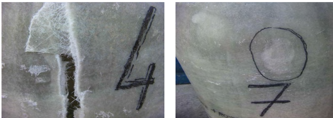
Slika 7. Uvećani prikaz ispitanih uzoraka posuda izrađenih od ojačanja u obliku mate (lijevo), odnosno kombinacija mata i rowing (desno)
