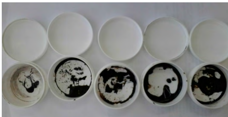
Slika 2. Ferro fluidi pripremljeni pri 10,20, 30, 40, 50 i 60 °C uz konstantnu brzinu taloženja i broj okretaja miješala.
