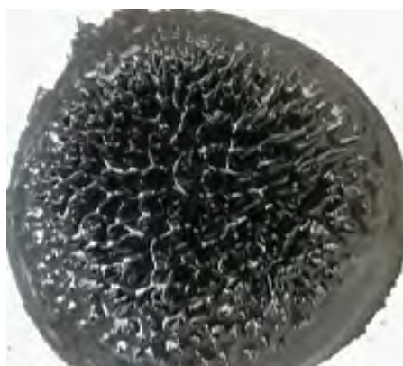
Slika 3. Djelovanje magnetnog polja na ferrofluid
