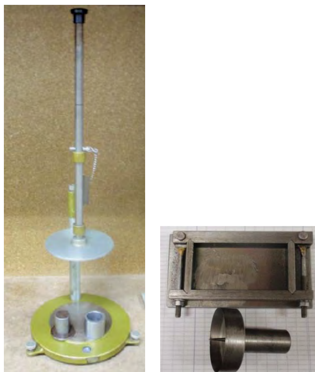
Slika 2. Pfefferkornov uređaj (lijevo) i kalup za pločice (desno)
