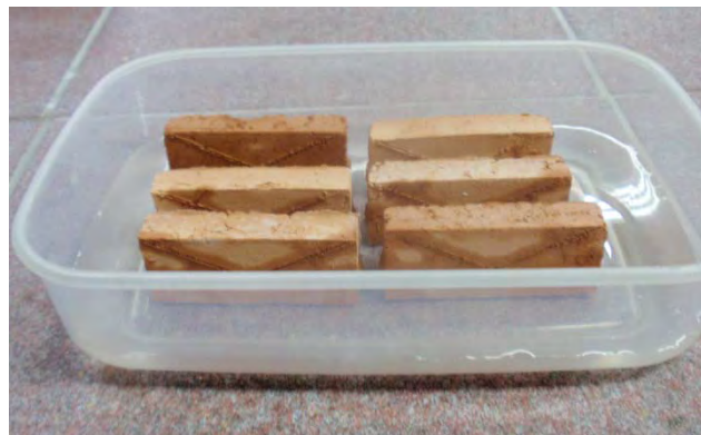
Slika 3. Pločice nakon pečenja (lijevo) i potapanje pločica u vodi (desno)
