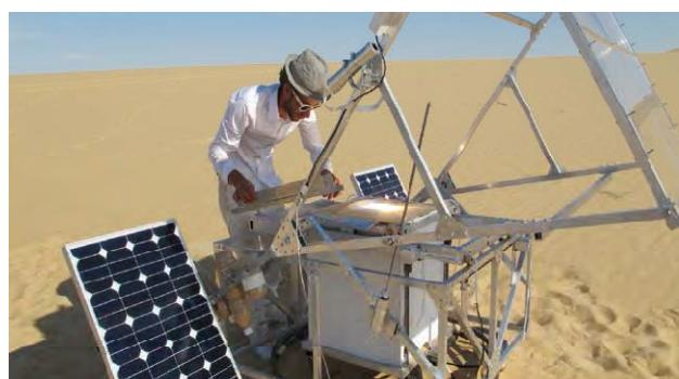
Slika 3 Printanje stakla u Sahari uz pomoć pijeska kao tinte i solarnog napajanja printerja [1]
