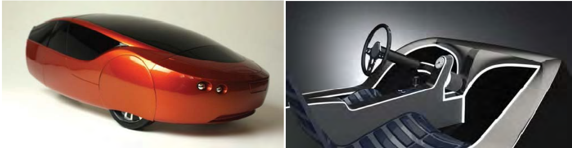
Slika 4. Urbee (“urban electric”) prvi svjetski 3D–printano automobilsko tijelo, ultra aerodinamičkog dizajna i visoke energetske efikasnosti. Automobil koristi obnovljive izvore energije (vjetar, solarnu energiju, energiju vode) i etanol za veće udaljenosti. Budući planovi uključuju 3D printanje komponenti interijera automobila. [3]
