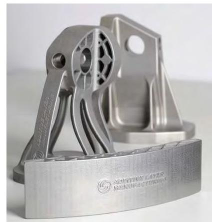
Slika 1. 3D printana konzola krila od metalnog praha [1]
