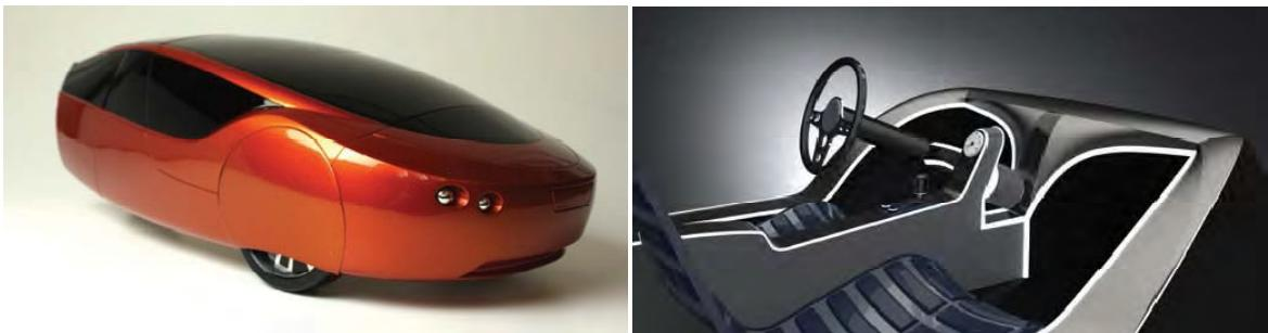
*Slika 4. Urbee ("urban electric") prvi svjestki 3D-printano automobilsko tijelo, ultra aerodinamičkog dizajna i visoke energetske efikasnosti. Automobil koristi obnovljive izvore energije (vjetar, solarnu energiju, energiju vode) i etanol za veće udaljenosti. Budući planovi uključuju 3D printanje komponenti interijera automobila. [3]*
