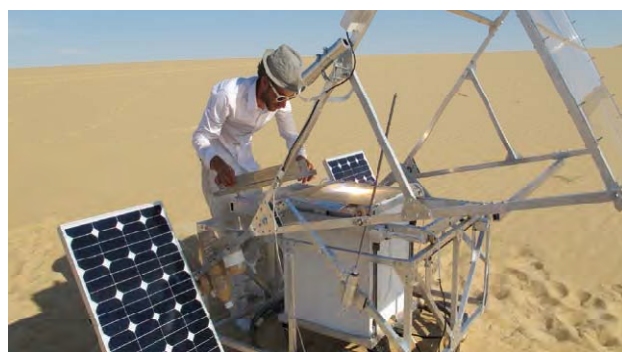
Slika 3 Printanje stakla u Sahari uz pomoć pijeska kao tinte i solarnog napajanja printera [1]
