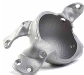
*Slika 6. Vještački kuk od Ti legure proizведен SLM tehnologijom [7]*
