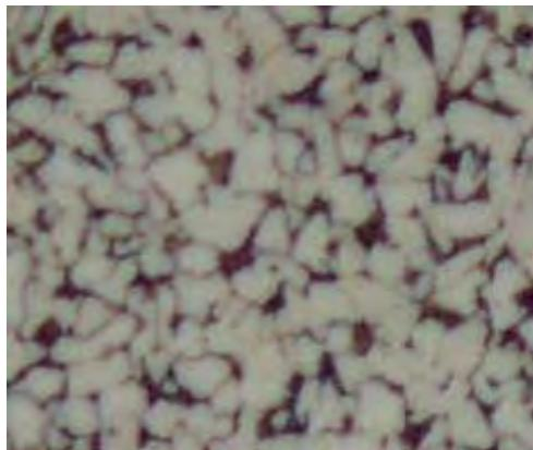
Slika 1. Snimak strukture glatke armature, uvećanje 100 X.
