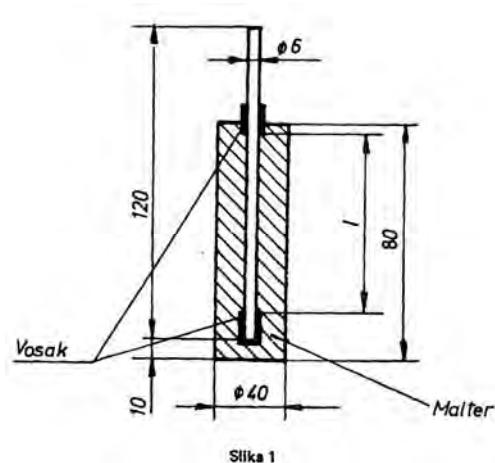
Slika 2. Oblik i dimenzije radne elektrode[3]
