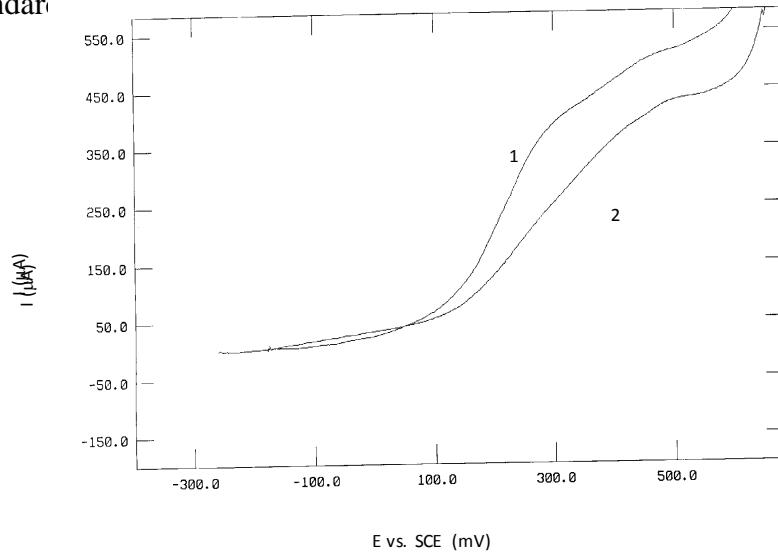
Slika 4. Anodne polarizacijske krive uzoraka čelične armature u betonu
