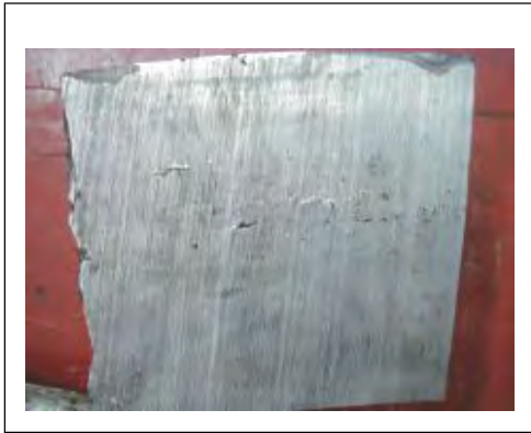
Slika 4. Izražena makroporoznost na cilindričnom dijelu rukavca
