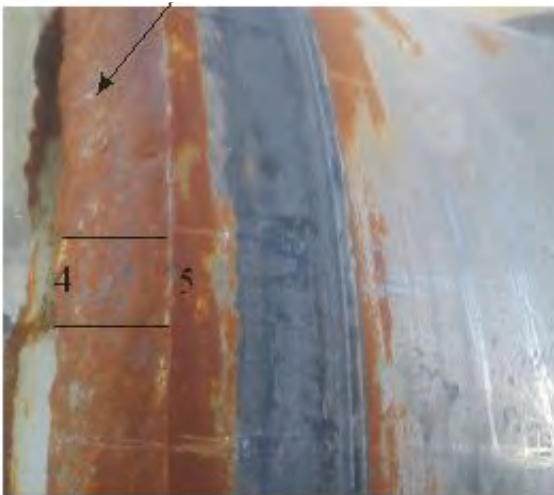
Slika 2. Lokacija uzimanja uzoraka za metalografska ispitivanja uz prijelom
