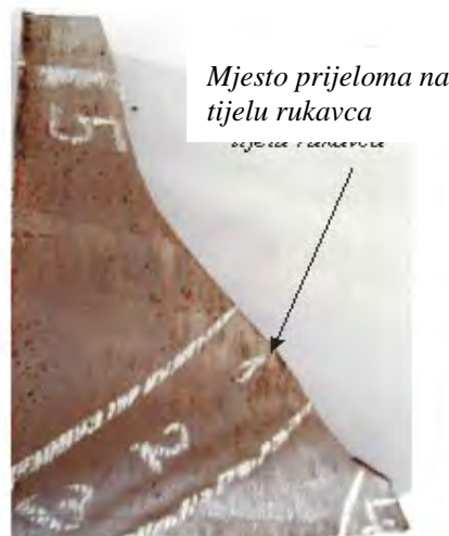
Slika 3. Lokacije uzimanja uzoraka uz prijelom i dalje po dužini cilindričnog dijela rukavca
