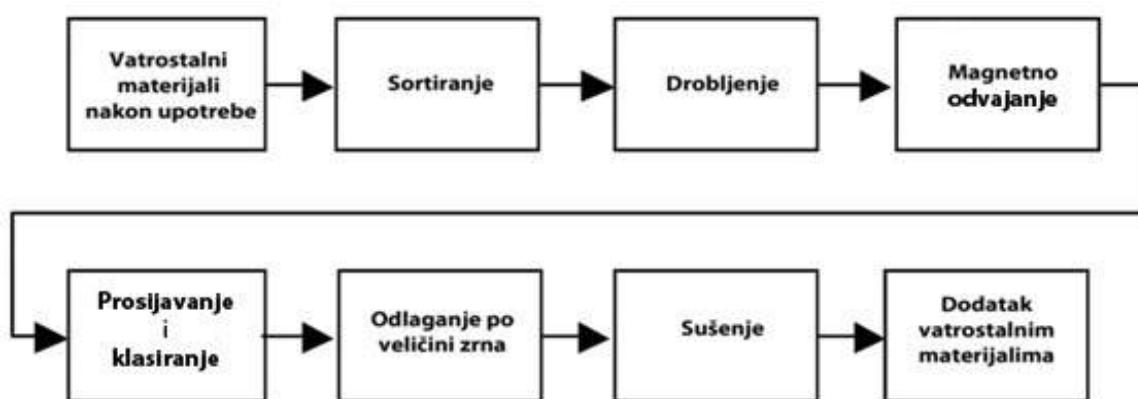
Slika 5. Shematski tok procesa reciklaže vatrostalnih materijala
