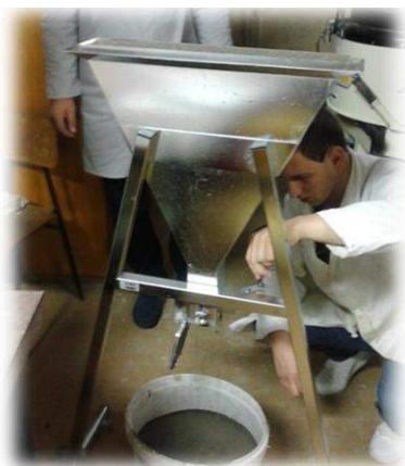
*Slika 4. Ispitivanje vremena tečenja kroz V-lijevak*
