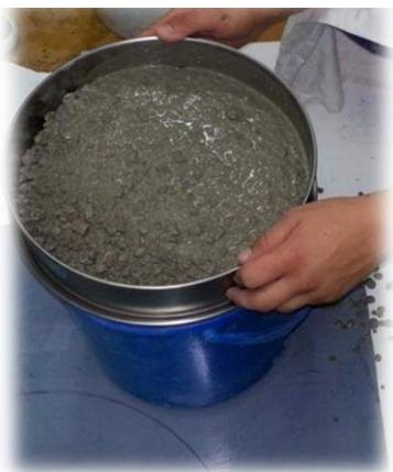
*Slika 6. Ispitivanje otpornosti na segregaciju*
