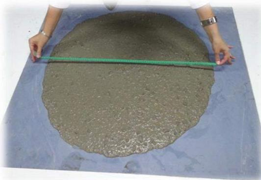
*Slika 2. Ispitivanje rasprostiranja slijeganjem*
