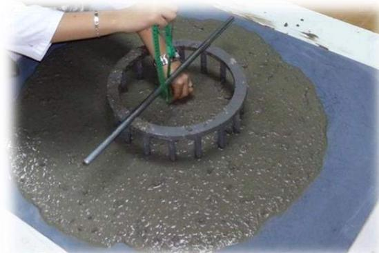
*Slika 3. Ispitivanje J-prstenom*
