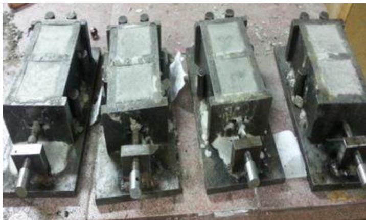
Slika 2. Prizmatični uzorci za ispitivanje pritisne čvrstoće prema normi EN 12390-3
