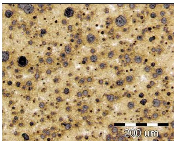
Slika 5. Mikrostruktura uzorka nakon termičkog tretmana, nagriženo-3%Nital, 100x
