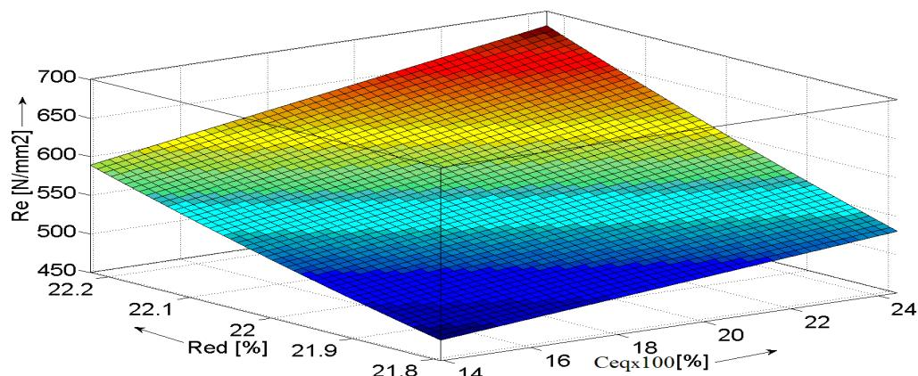
*Slika 2. Granica tečenja ( $R_e$ ) vučene žice  $\Phi 8 \text{ mm}$  u ovisnosti od ( $C_{ekv.}$ ) i redukcije [5].*
