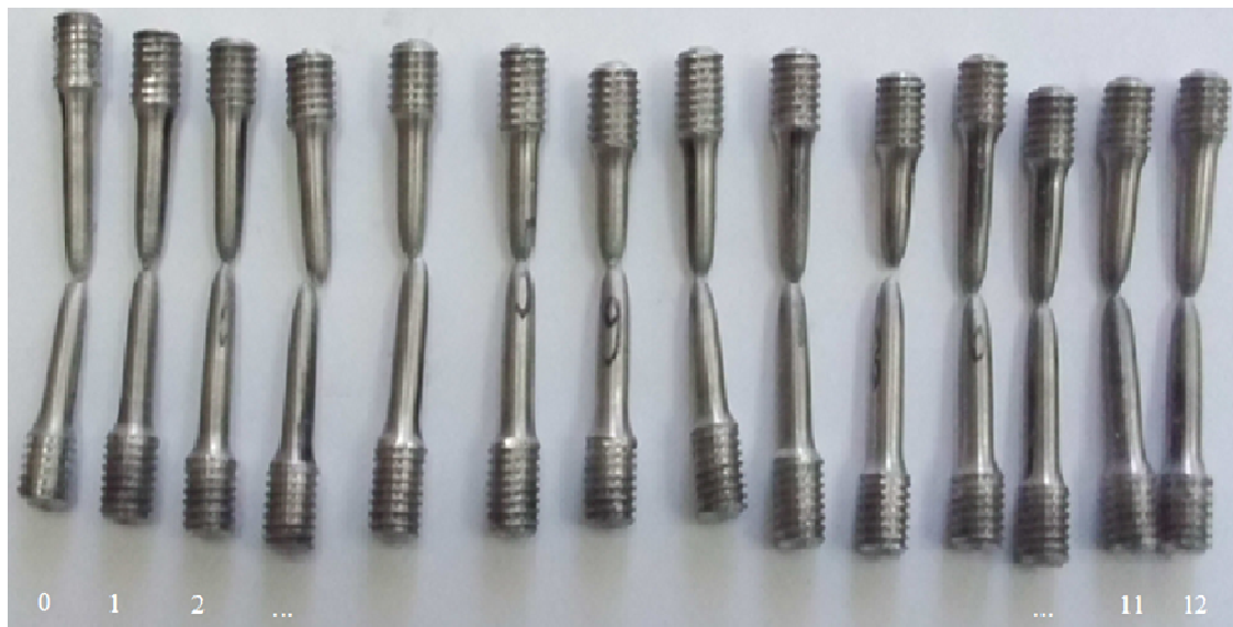
Slika 6. Ispitne epruvete nakon ispitivanja na zatezanje poslije prve faze IHRIV
