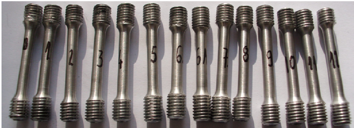
Slika 5. Pripremljene epruvete iz Al 99,5 nakon prve faze IHRIV za ispitivanje zatezanjem
