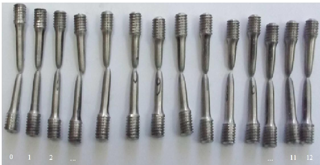
Slika 6. Ispitne epruvete nakon ispitivanja na zatezanje poslije prve faze IHRIV
