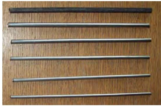
Slika 3 Tehnološke epruvete za ispitivanje zatezanjem
