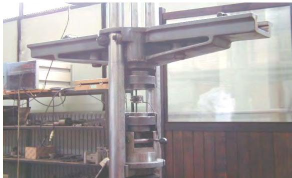
Slika 4. Položaj epruvete u kidalici
